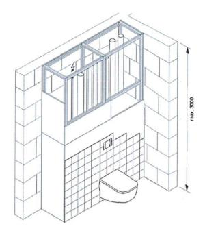
rückwärtige Wand wird durch angrenzende Massivwand gebildet, restliche Wände in Massiv- oder Leichtbauweise gem. Abschnitt 2.1
